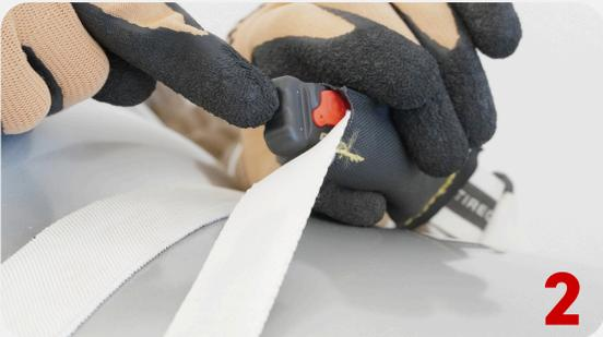
Stellen Sie sicher, dass der rote Gummischutz des Sensors zum Gurt hin ausgerichtet ist.
