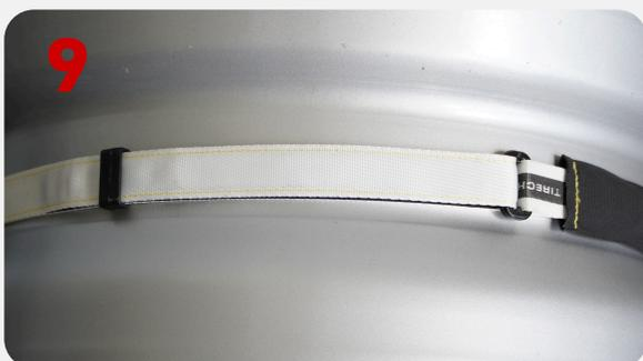
Schieben Sie die Kunststofföse ca. 25 mm über das Ende des Gurtes. Die Position des Sensors hat keinen Einfluss auf die Genauigkeit der Funktion, sollte jedoch nicht direkt über einem Ventil oder Ventilloch positioniert sein (der Sensor sollte vollen Kontakt mit der Felge haben).
