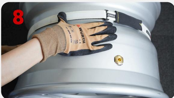
Achten Sie darauf, dass das Ende des Gurtes gut angedrückt und gesichert ist. Um den Druck zu erhöhen und die Verbindung zu verbessern, kann ein rundes Werkzeug oder das Ende eines Schraubenziehers verwendet werden.
