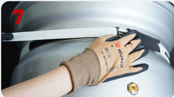
Schließen Sie den Klettverschluss und achten Sie darauf, dass der obere und untere Gurt richtig ausgerichtet sind.
