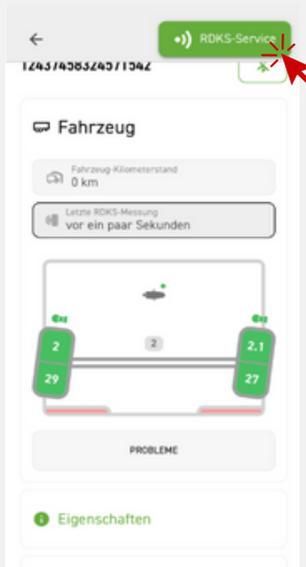
1. Fahrzeugschema, Echtzeit-Daten zu Luftdruck und Temperatur werden angezeigt
