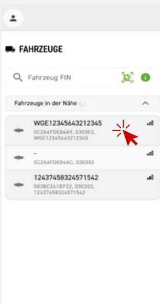
1. Fahrzeuge in der Nähe werden automatisch erkannt. Um eine Verbindung herzustellen das Fahrzeug aus der Liste auswählen und verbinden. (Sicherstellen, dass die Zündung eingeschaltet ist)
